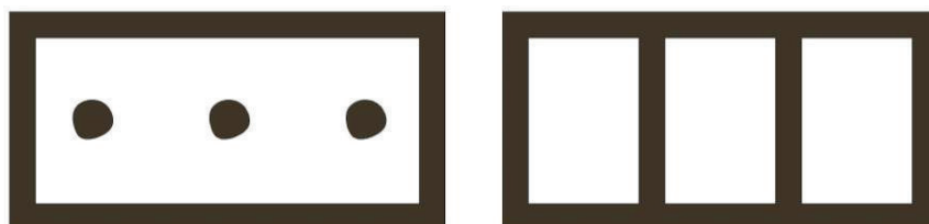
Skica 1: Nanašanje lepila na izolacijske plošče
